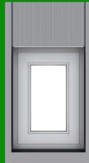
Thermisch getrenntes Fensterbank-Formteil mit Clipsvorrichtung für jedes Fensterprofil KF/ Holz.
